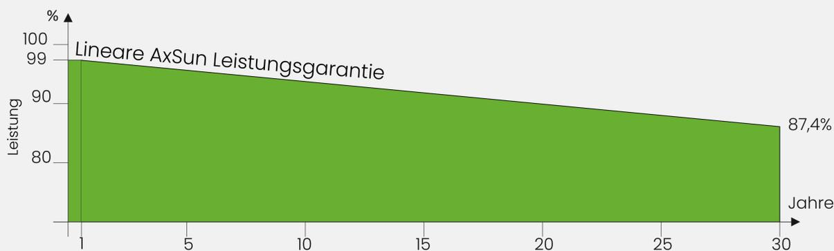
Die Module liefern im ersten Jahr nach Garantiebeginn mindestens 99 % der Nennleistung, danach sinkt sie jährlich um maximal 0,4 %, sodass nach 30 Jahren noch mindestens 87,4 % der Nennleistung erreicht werden.
